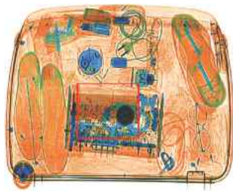
X-АСТ автоматически маркирует подозрительные объекты
